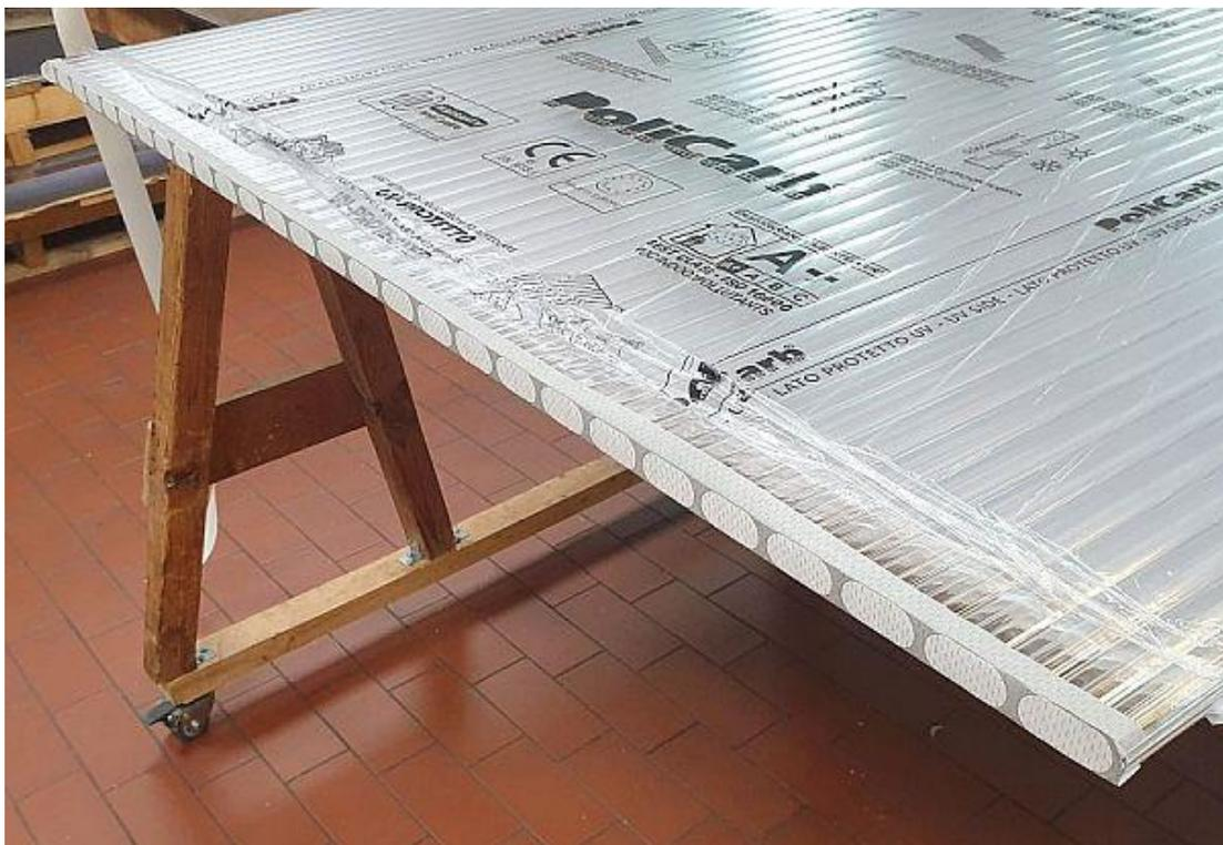
Beide Enden der Stegplatte sind mit dem Kantenabschlussband verschlossen
