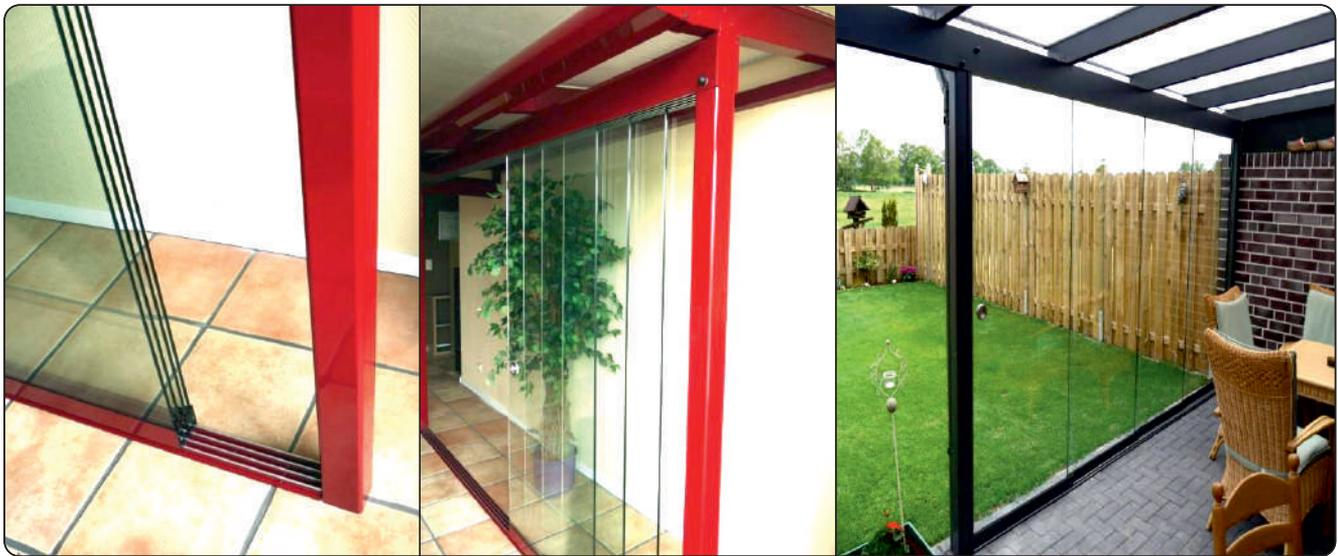
Das Schiebetürsystem besteht aus einem Aluminium Oberprofil (als Führung) und einer Aluminium Unterschiene, auf welcher die einzelnen Glasteile auf Rollen gelagert laufen. Somit ist ein einfaches Verschieben garantiert. Die Oberschiene ist nicht sichtbar im Querträger des Komplettsystems montiert. An der Unterseite der Glaselemente wird ein Laufwagen angebracht, welcher auf der am Boden verschraubten Unterschiene läuft.
