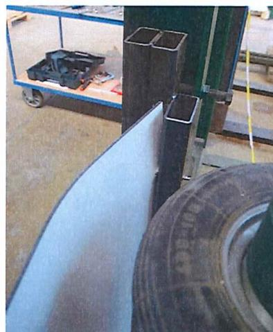
Abbildung 7: plastische Verformung im auflagenahen Bereich am oberen freien Rand infolge einer Anprallenergie von 100 Nm
