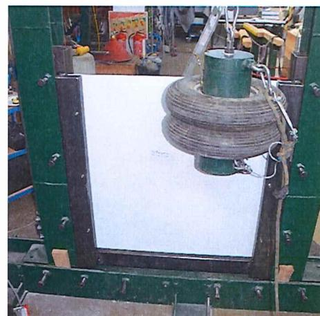
Abbildung 5: Versuchsaufbau einer stoßartigen Beanspruchung im auflagernahen Bereich
