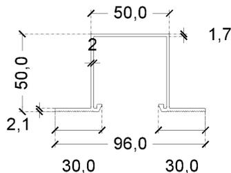
Hutprofil (vertikales Tragprofil) [mm]
